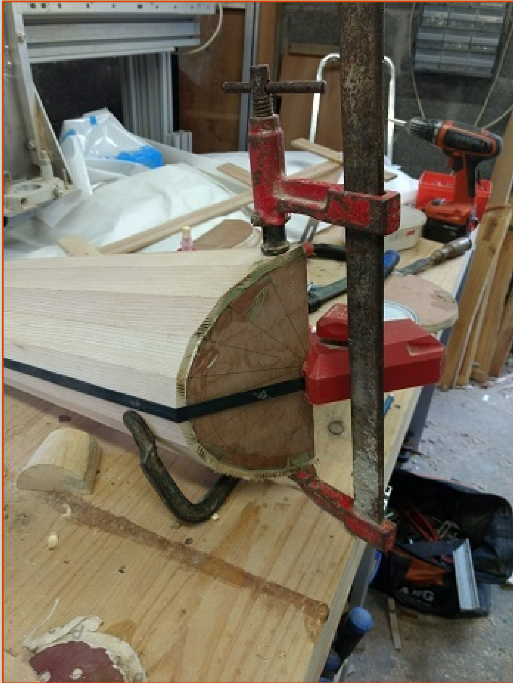
Collage de la base de la caisse de résonance
