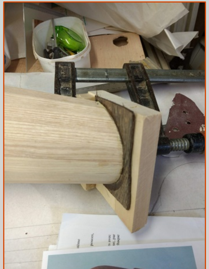
Collage de la tête de la caisse de résonance
